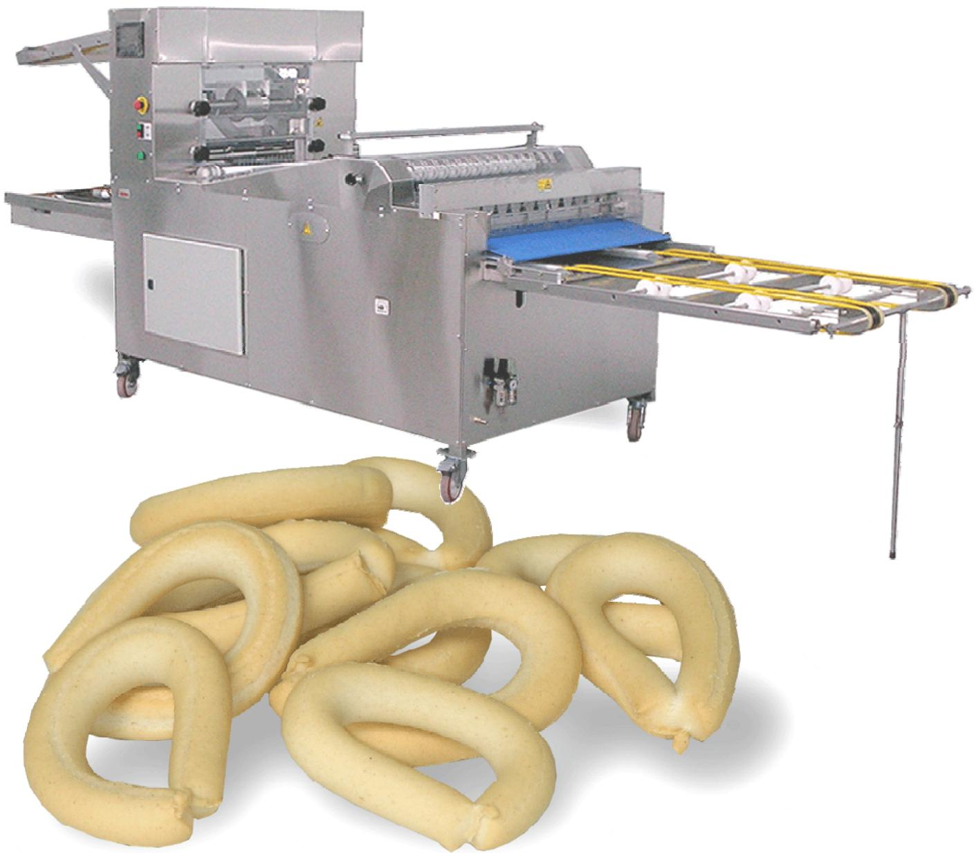
Formadora de rosquillas, violines, colines y regañá. Opcionalmente también puede fabricar ochitos. La lona de entrada junto con el pre-laminador de masa regulable en velocidad y apertura, permiten un trabajo más cómodo. Dos fotocélulas detectan el sobrante de masa, deteniendo e iniciando el prelaminador para una alimentación continua.
